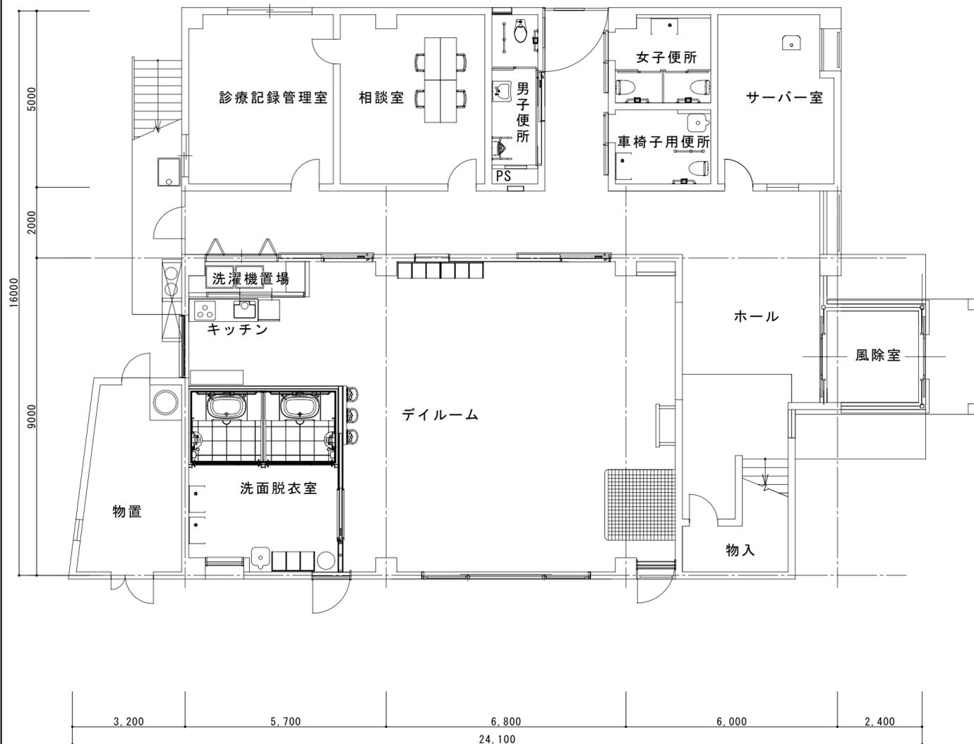
1階平面図 (改修後)
